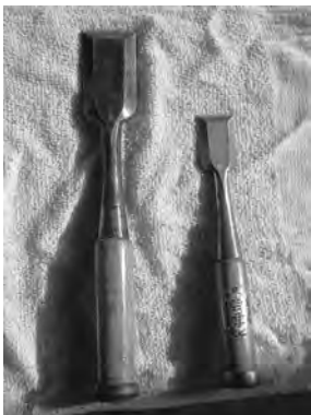
写真1 叩き鑿(左)大入れ鑿(右) 図2 鑿の構造
